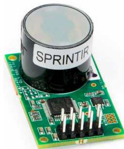
Figura 2.11: Sensor de bióxido de carbono SprintIR®-W [28].
