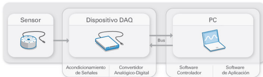
Figura 2.1: Diagrama de las partes de un sistema de adquisición de datos[13].
